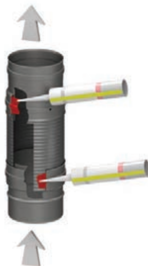
Montaż w przypadku pracy w naciśnieniu.
